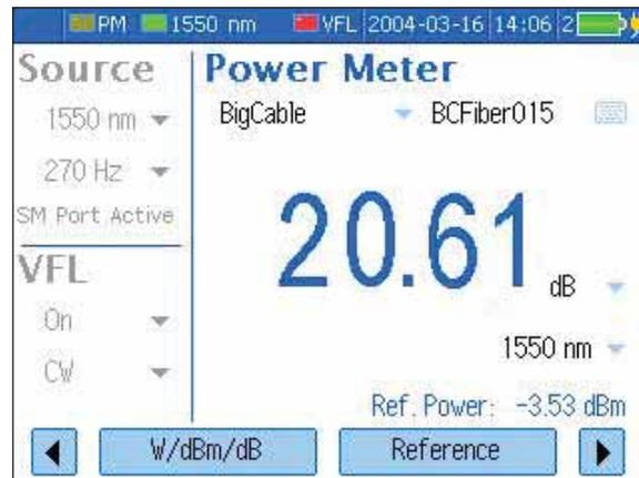
FOT-930 позволяет вам использовать источник высокой мощности, измеритель высоких уровней мощности, а также переговорное устройство и визуальный дефектоскоп – все одновременно.
